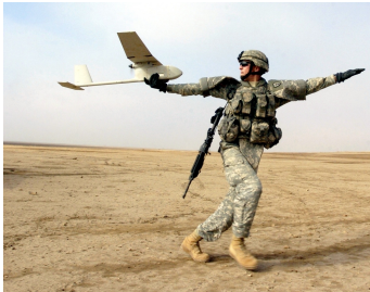
(d) RQ-11 Raven 130cm wingspan 1.9kg typical
