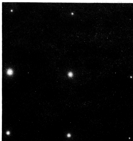
Figura 7a. Micrografía en campo claro de una aleación de Al-4% Cu envejecida a 300° C por 5.5 h. La orientación de un grano es [100] y la del otro grano es cercana a [100]. La imagen se formó teniendo varios haces fuertemente difractados. Nótese los precipitados \theta en el límite entre los dos granos y en la superficie de los precipitados \theta' . Figura 7b. Patrón de difracción de una aleación Al-4% Cu con precipitados \theta . La orientación es [100]. Las reflexiones de la fase \theta se identifican en el esquema. La orientación cristalográfica entre matriz y precipitados es (110)_{\alpha} // (100)_{\theta} y \langle 001 \rangle_{\alpha} // \langle 001 \rangle_{\theta} .
